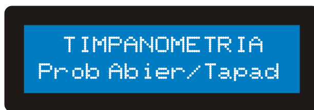
Figura 4.1.2: Indicación de Probeta Abierta o Tapada.
