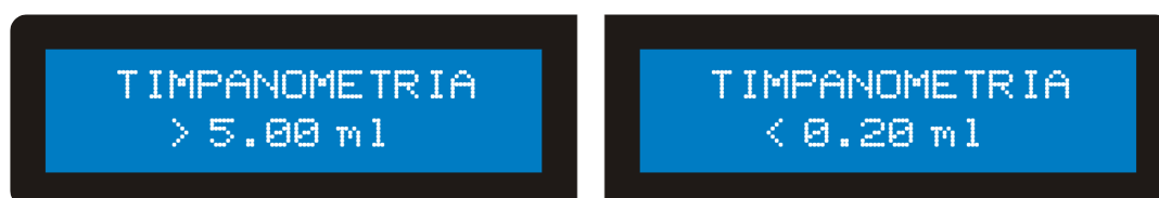
Figura 4.1.3: Indicación de niveles de compliancia fuera del rango de medición del equipo.
