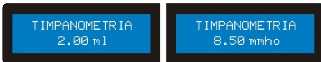
Figura 4.1.1: Indicación de timpanometría absoluta o medición de compliancias y/o cavidades (izquierda con tono de 226 Hz, derecha (función opcional) con tono de 1 kHz).
