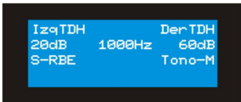
Figura 5.2.4: Ejemplo de estimulación con tono modulado y enmascaramiento sincronizado.
