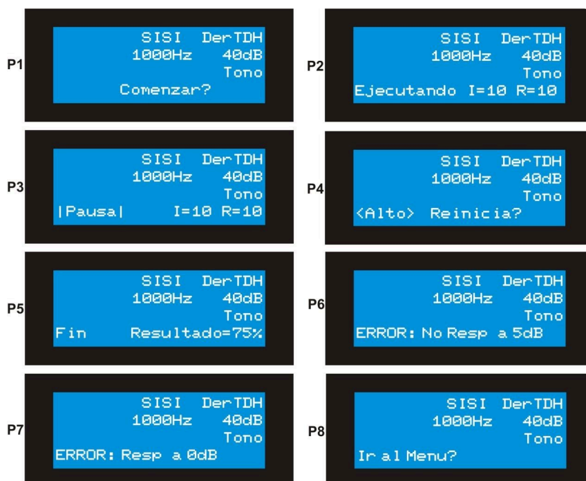
Figura 6.5.2.2: Prueba Automática de S.I.S.I.
