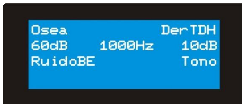
Figura 6.2.1.1: Ejemplo de Ósea Inversa: salida de ruido por vibrador óseo y tono por auricular derecho.
