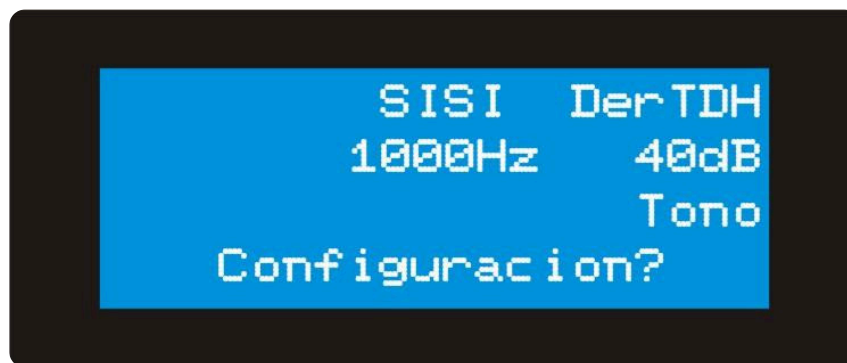
Figura 6.5.2.1: Pantalla inicial en la prueba de S.I.S.I.
