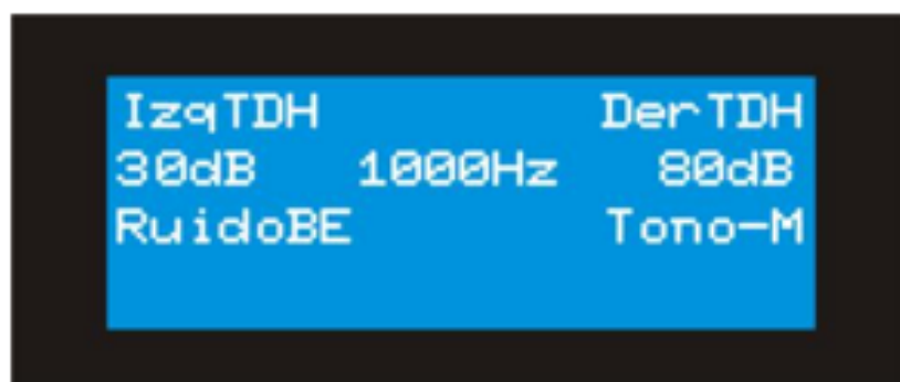
Figura 5.2.2: Ejemplo de estimulación con tono modulado (Tono-M) por el auricular derecho con enmascaramiento por el izquierdo.
