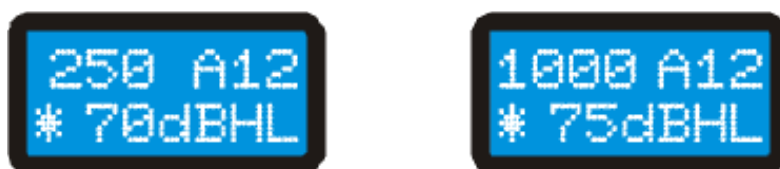
Figura 5-9: Valores guardados en el Banco 12 para Vía Aérea con TDH-39, en las frecuencias 250 Hz y 1000 Hz.
